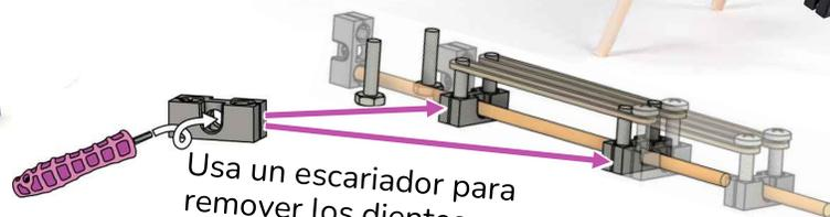
Usa un escurridor para remover los dientes y que el émbolo se pueda deslizar.
