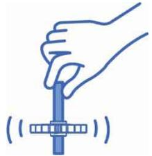
**1** **Engrana** (conecta) dos engranes de 40 dientes en la base. Usando el eje, gira el **Engrane A** en sentido horario (dirección de la flecha) una **revolución**. Dibuja una **rotación** en el **Engrane B** para mostrar la dirección de **rotación** (giro).
